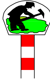
Slika 5: Pri signalni oznaki »Mesto dela na progi« strojevodja oddal signalni znak "Pazi" – en dolg pisk s sireno. Delavci ali stroji se morajo takoj umakniti s proge – iz normalnega svetlega profila tira
